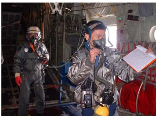
圖 2、空中人工增雨作業主要原理，主要是藉助催化劑的使用，讓雲滴加速長大，使得整個降雨過程更有效率，圖為在機上進行空中施灑吹化劑作業實況
