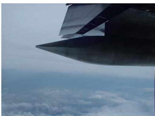
圖 4、空中人工增雨施灑催化劑作業，建議在目標處的上風位置，採盤旋來回方式進行
